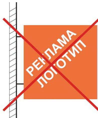
расположение рекламной конструкции перпендикулярно стене крепления
