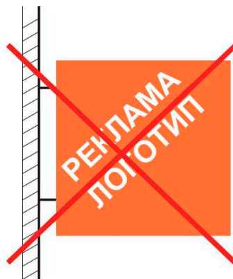
расположение рекламной конструкции перпендикулярно стене крепления
